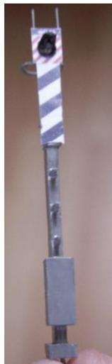
starkem PS-Röhrchen von Plastruct gefertigt und anschließend schwarz eingefärbt.
