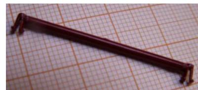
Die beiden nicht benötigten Enden werden möglichst rechtwinklig abgeschnitten. Dann erfolgt eine Bohrung ca. 10 mm tief direkt in die Stirnseite der Schnittstelle. Eine weitere Bohrung wird am gegenüber liegenden Ende quer durch den Kuppelbaum, ca. 1,5 mm vom Ende entfernt, getrieben. In diese Bohrungen kommen später zurecht gebogene Edelstahldrähte. Ich verwende dafür Edelstahldraht mit einem Durchmesser von 0,5 mm und dementsprechend auch einen Bohrer mit 0,5 mm Durchmesser.
