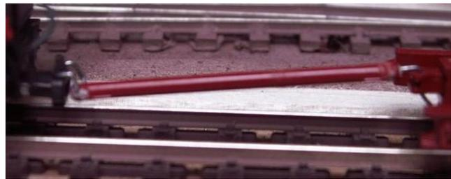
Bislang gab es im Betrieb keine Störungen mit dieser Konstruktion. Zum Abkuppeln einfach den Haken von der Lok- bzw. Wagenkupplung heben und dann Kuppelbaum vom Rollwagen abheben – auf der anderen Seite der Rollwagenkomposition einhängen, Lok und/oder Wagensatz ankuppeln und der Rollwagenzug steht schon zur Rückfahrt bereit.
